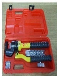
MAQUINA DE CRAVAR CABO DE AÇO NOS ESTICADORES.
